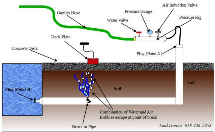
FOR A VIDEO ON HOW TO USE THE PRESSURE RIG - VISIT WWW.LEAKTRONICS.COM
